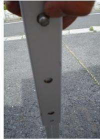
上の写真のポッチの部分を押してフレームの足を下に引っ張って下さい。指を挟むとケガしますので必ず軍手をはめて行って下さい。このポッチを伸ばすことで
