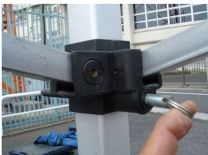
最後まで引っ張ると上の写真の部分が「カチャ！」と音がします。ダブルリングを引っ張るとフレームが自由になります。
